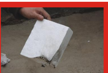
●白桦林间外墙外保温材料用打火机等小火难以点燃
