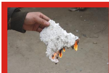
●不具阻燃作用的普通保温材料用打火机即可点燃
