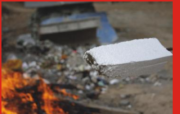
●白桦林间外墙外保温材料离开火焰后不带有明焰
